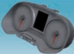
**Calculateur dans le combiné d'instruments J285**
