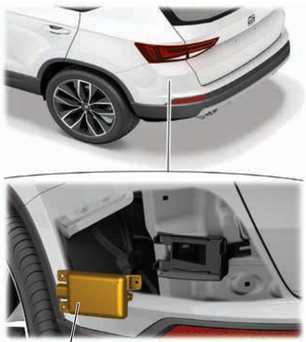
Emplacement de montage du calculateur du système de détection d'angle mort
