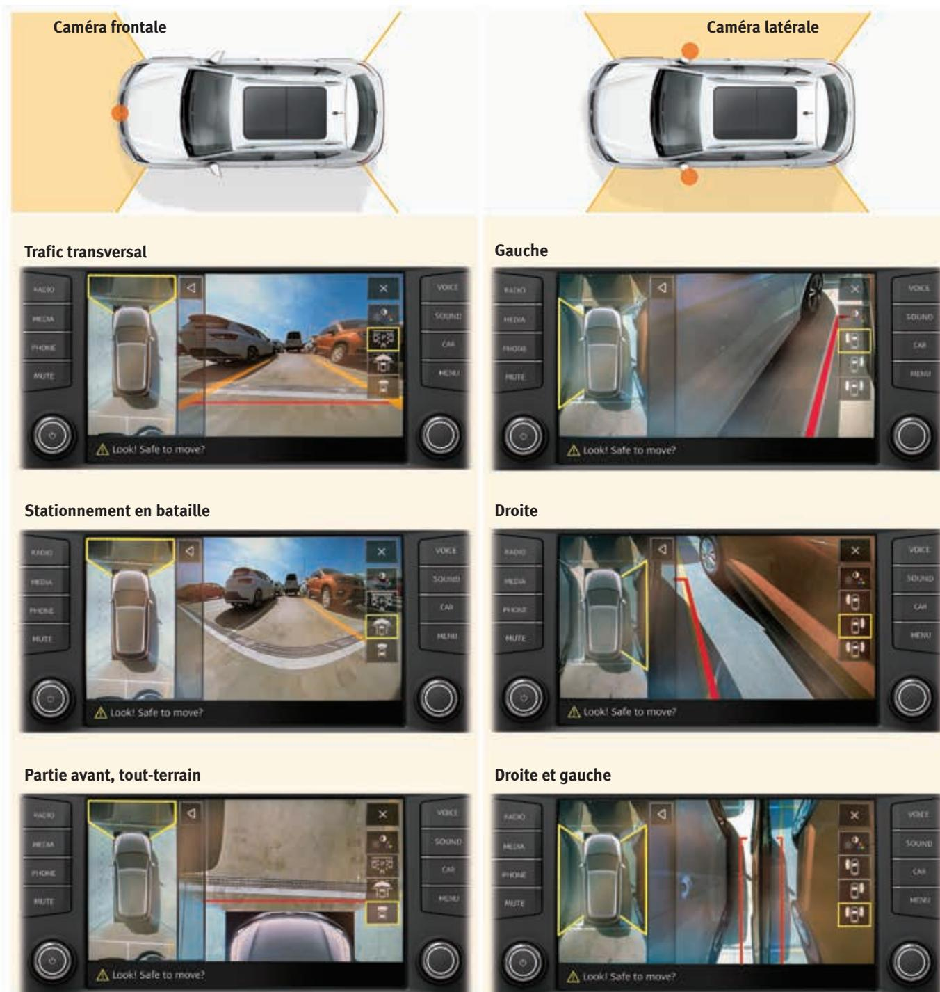
Le système de vision périphérique (Area View) permet de sélectionner différentes vues de l'environnement proche du véhicule.
