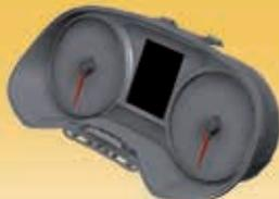
**Calculateur dans le combiné d'instruments J285 :**
