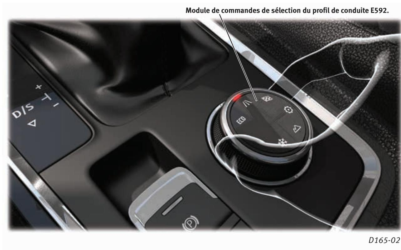
La fonction SEAT Drive Profile permet au conducteur de sélectionner jusqu'à 6 modes de conduite.
